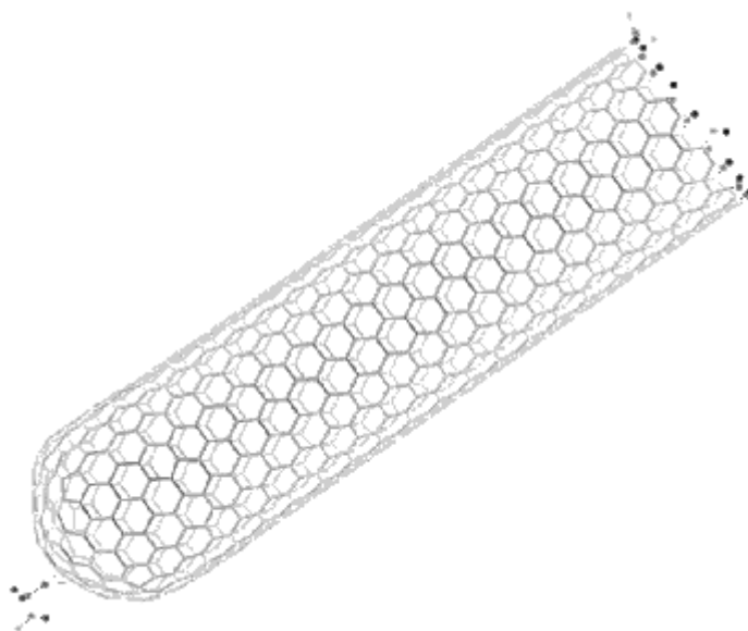
Рисунок 1.4 – Нанотрубка с хиральностью (10,10) (конфигурация «Кресло») [21]
