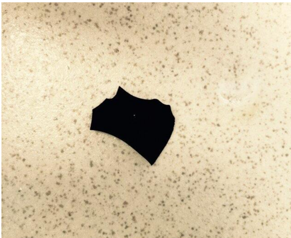
Рисунок 3.4 – Внешний вид мембраны АОА после синтеза УНТ
